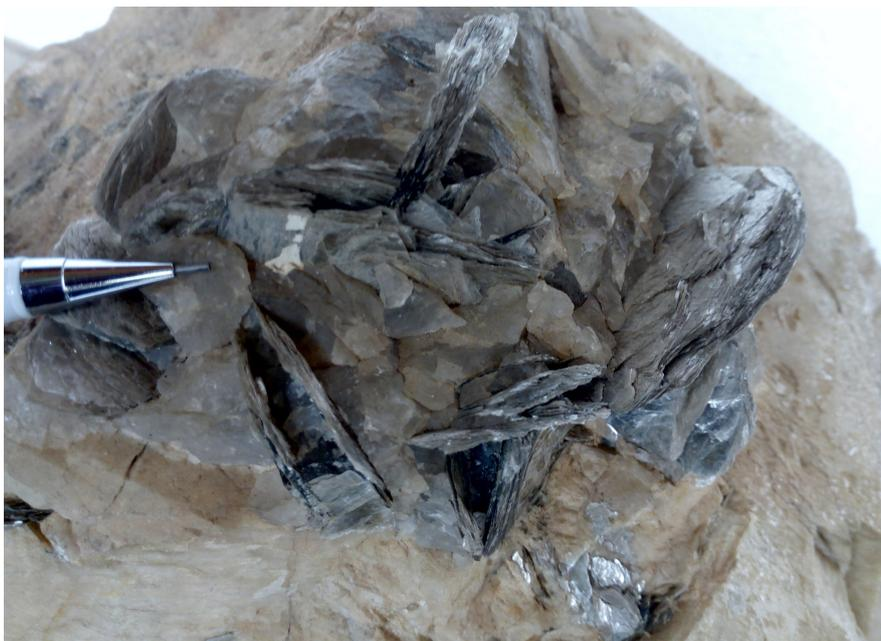
**Figura 9.** Detalhe de cristais bem formados de muscovita em amostra de pegmatito quartzo-feldspático. Esse tipo de rocha é a principal fonte para a produção de muscovita, tanto na variedade em folhas, quando as placas são bem formadas e livres de imperfeições, como para produção de mica moída. Foto: acervo do autor.
