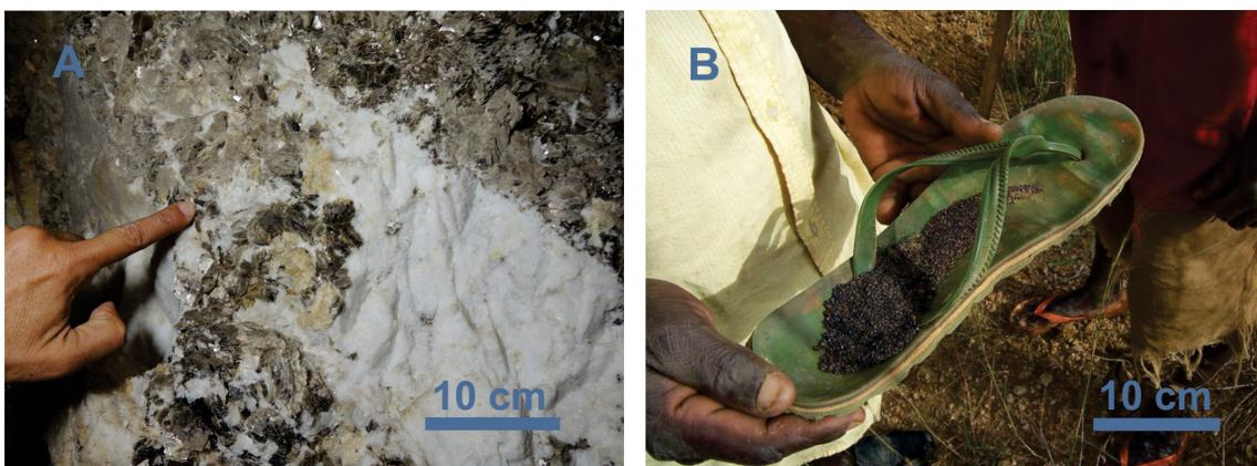
**Figura 3.** A) Grão milimétrico de cassiterita em pegmatito da Lavra Itatiaia II, município de Conselheiro Pena (MG) (Foto dos Autores). B) Concentrado aluvionar de cassiterita de Jos Plateau, Nigéria (foto: Wolfgang Hampel).
