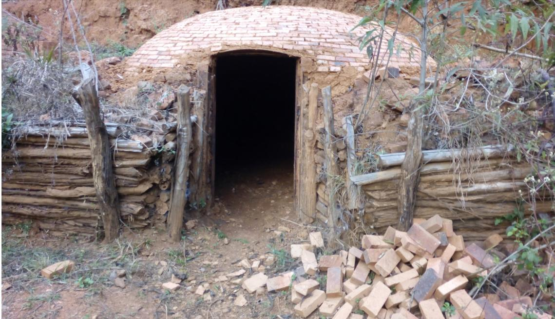
**Figura 7.** Detalhe de forno rústico construído com tijolos de argila e usado para produzir carvão vegetal a partir da queima da madeira de eucalipto. Foto: Acervo pessoal do autor.
