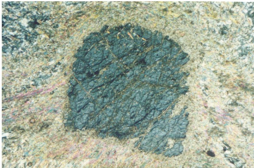
**Figura 5.** Desestabilização de um cristal de andaluzita em pirofilita e diásporo no agalmatolito de Pará de Minas; porfiroblasto com 2 mm de diâmetro; luz analisada (Romano 2006, 2007).
